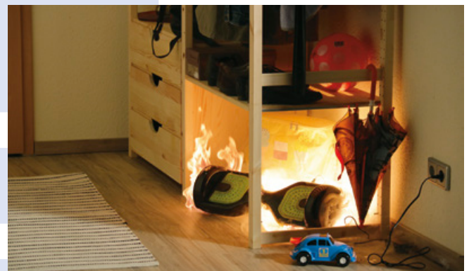
Der Akku eines Hoverboards geht beim Laden im Wohnungsflur thermisch durch.
